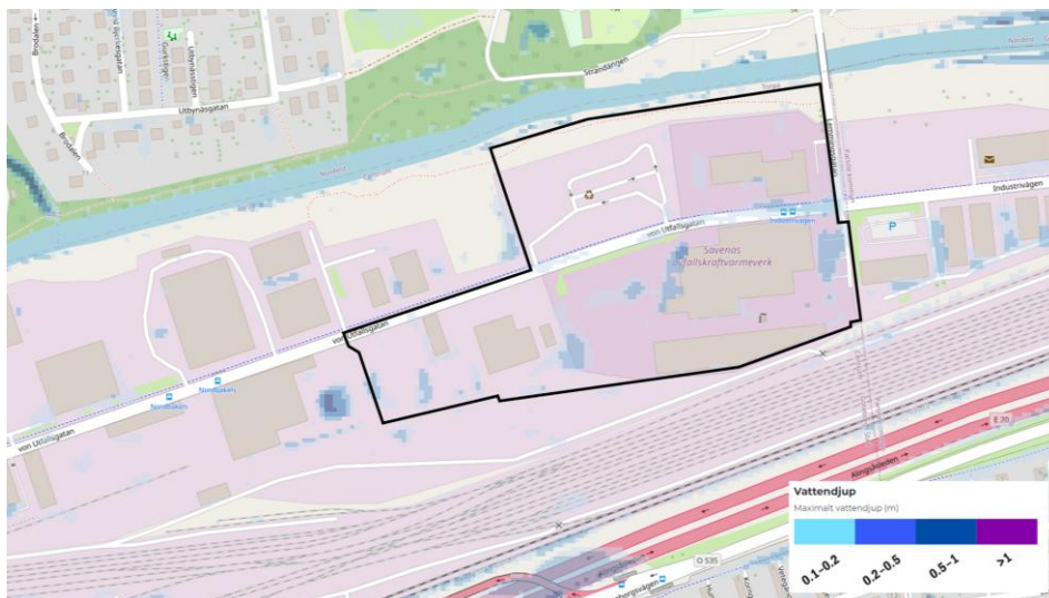
Figur 2-10. Befintlig översvämningsituation vid klimatanpassat 100-årsregn (Göteborgs stad, 2023).
