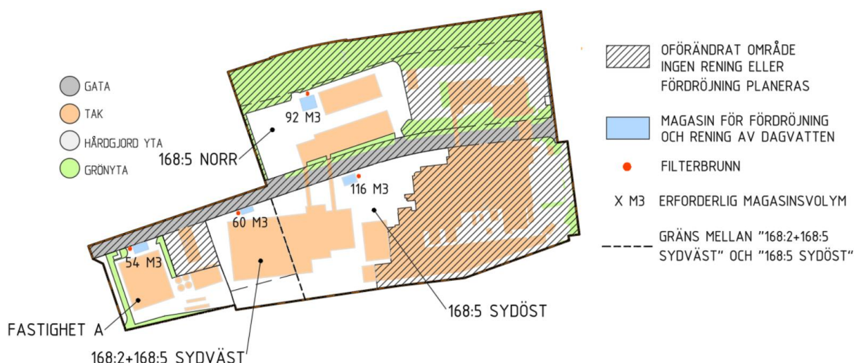
Figur 4-1 Övergripande avvattningsplan med erforderliga fördröjningsvolym. Dagvattnet leds till magasinerna via dagvattenbrunnar och ledningar.
