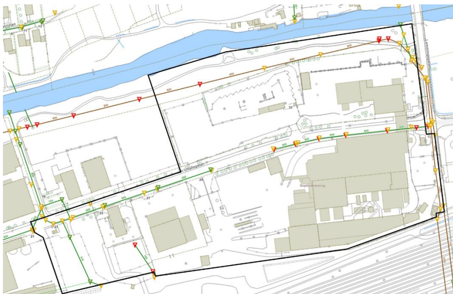
Figur 2-4. Befintligt ledningsnät inom planområdet. Trianglar visar vattennivåer i ledningsnätet vid ett 10-årsregn. Grön markering indikerar vattennivåer under ledningens hjässa, gul över hjässan och röd över marknivå.
