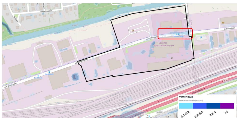
Figur 2-1. Befintlig översvämningssituation vid klimatanpassat 100-årsregn där översvämning i von Utfalls östra del markeras med rött (Göteborgs stad, 2023).
